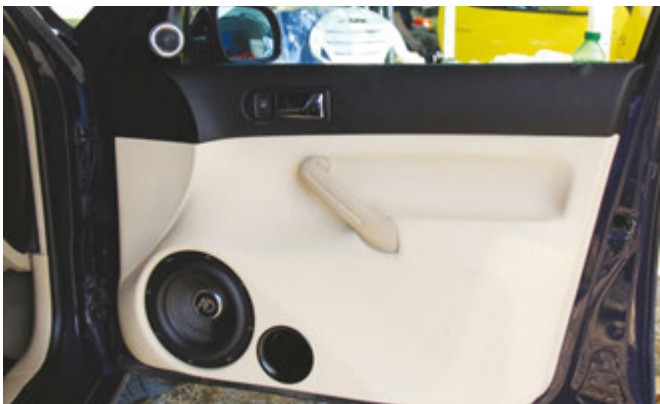
La Golf 4 di Roberto Marongiu ha dimostrato un incredibile livello di raffinatezza nelle lavorazioni. Ma anche soluzioni alquanto originali. A partire dal 20 centimetri AD in portiera in un volume accordato in reflex, al due vie a cruscotto, ad un bagagliaio semplicemente straordinario.
