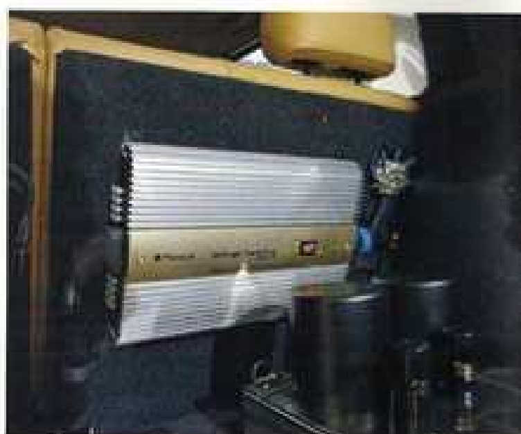
Una delle new-entry della nuova versione dell'impianto. È lo stabilizzatore Phonocar PTV16: il suo ruolo è quello di mantenere costante la tensione della corrente in arrivo alle elettroniche. Più corrente "pulita" migliora le prestazioni degli amplificatori.
